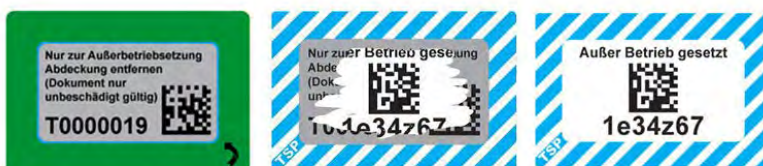
Grafik 2: Sicherheitscode auf Zulassungsbescheinigung Teil I, die Freilegung des Sicherheitscodes ist nicht umkehrbar
